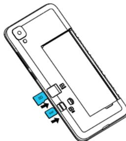
**NOTA:** Ya hay una tarjeta SIM de Verizon instalada en su dispositivo. Este diagrama muestra la ubicación de la tarjeta SIM por si desea quitarla o reemplazarla.
